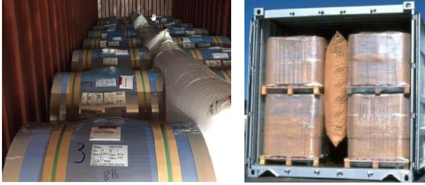
Őekil-35: Konteyner ii Yk Bloklama
