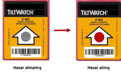
Şekil-24: Eđim Göstergesi Hasar Gösterimi
