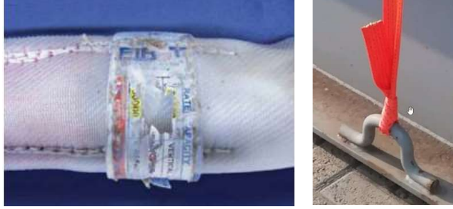
Őekil-38: Kullanılmaması Gereken Spanzet
